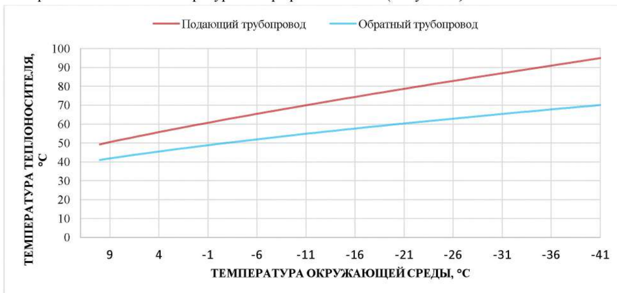
Рисунок 4 – Температурный график отпуски тепла от котельных «Центральная» и «д/сад "Светлячок"»
