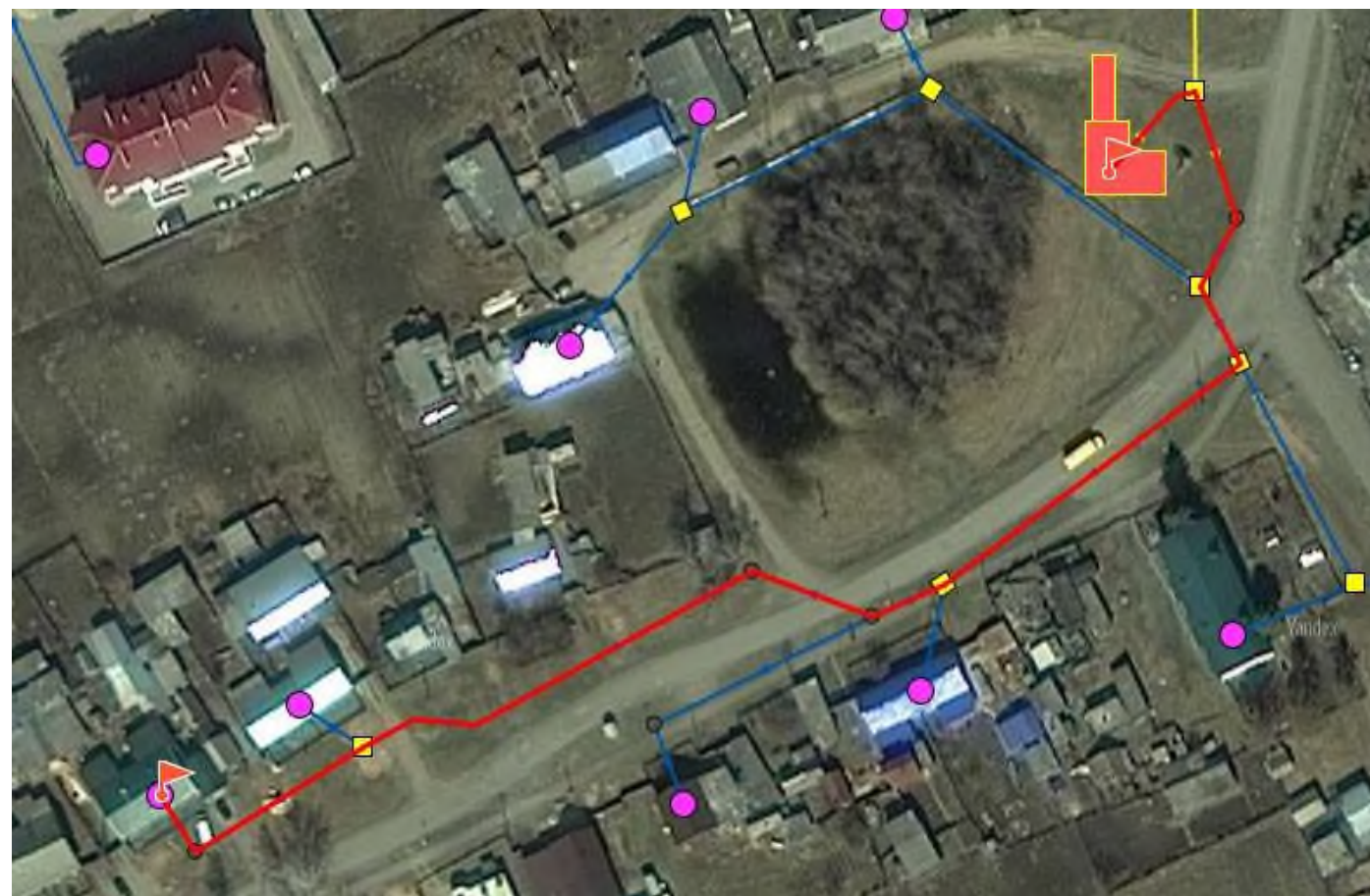
Рисунок 1.29 Путь построения пьезометрического графика газовой котельной «ДРСУ»
