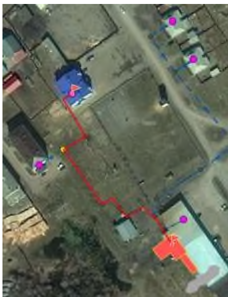
Рисунок 1.43 Путь построения пьезометрического графика котельной «Пожарная часть»
