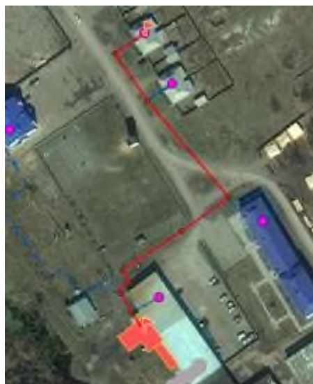
Рисунок 1.45 Путь построения пьезометрического графика котельной «Пожарная часть»
