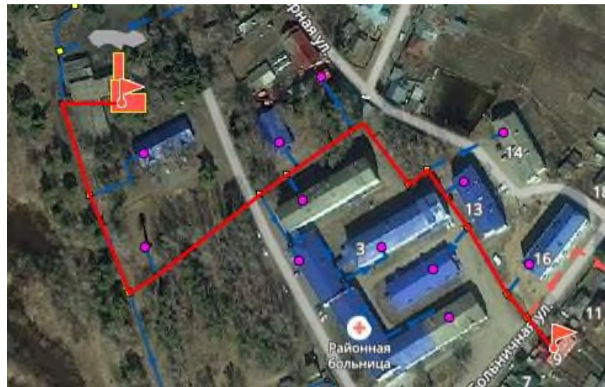
Рисунок 1.25 Путь построения пьезометрического графика котельной «ЦРБ»
