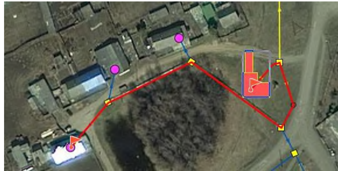
Рисунок 1.27 Путь построения пьезометрического графика газовой котельной «ДРСУ»
