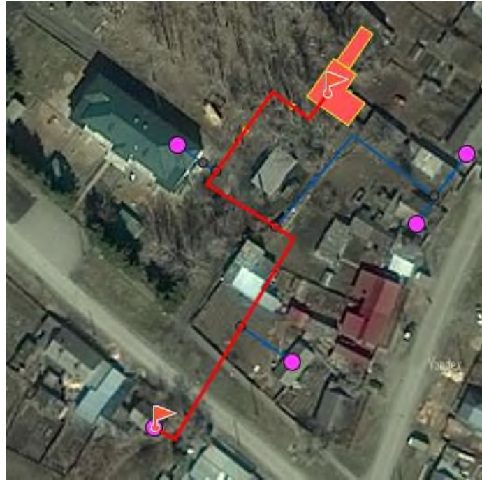
Рисунок 1.33 Путь построения пьезометрического графика АИТ д/с «Березка»
